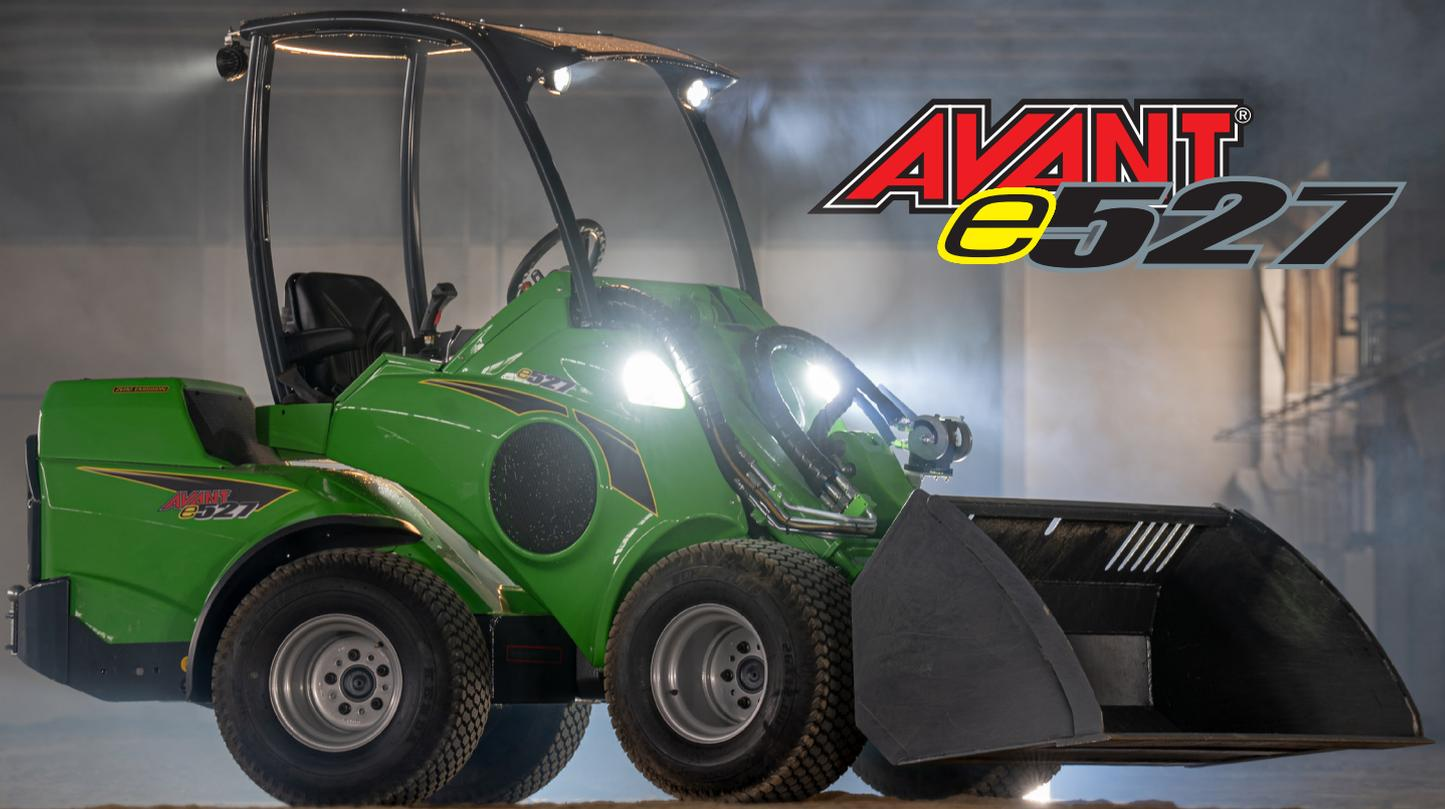
Der vollelektrische Avant Multifunktionslader E527 überzeugt dank dem großen 27 kWh Akku, mit einer Arbeitszeit von 6 Stunden sowie der Schnellladefunktion mit einer Ladezeit ab 70min, je nach Ladegerät.
