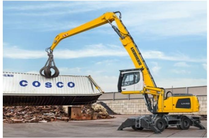
Containerzerlegung mit dem LH 40 M Industry Litronic
