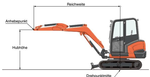
\* Die technischen Daten über den Arbeitsbereich der Maschine wurden mit dem Kubota Standard - Tieflöffel ermittelt, ohne Schnellwechsellinrichtung.
